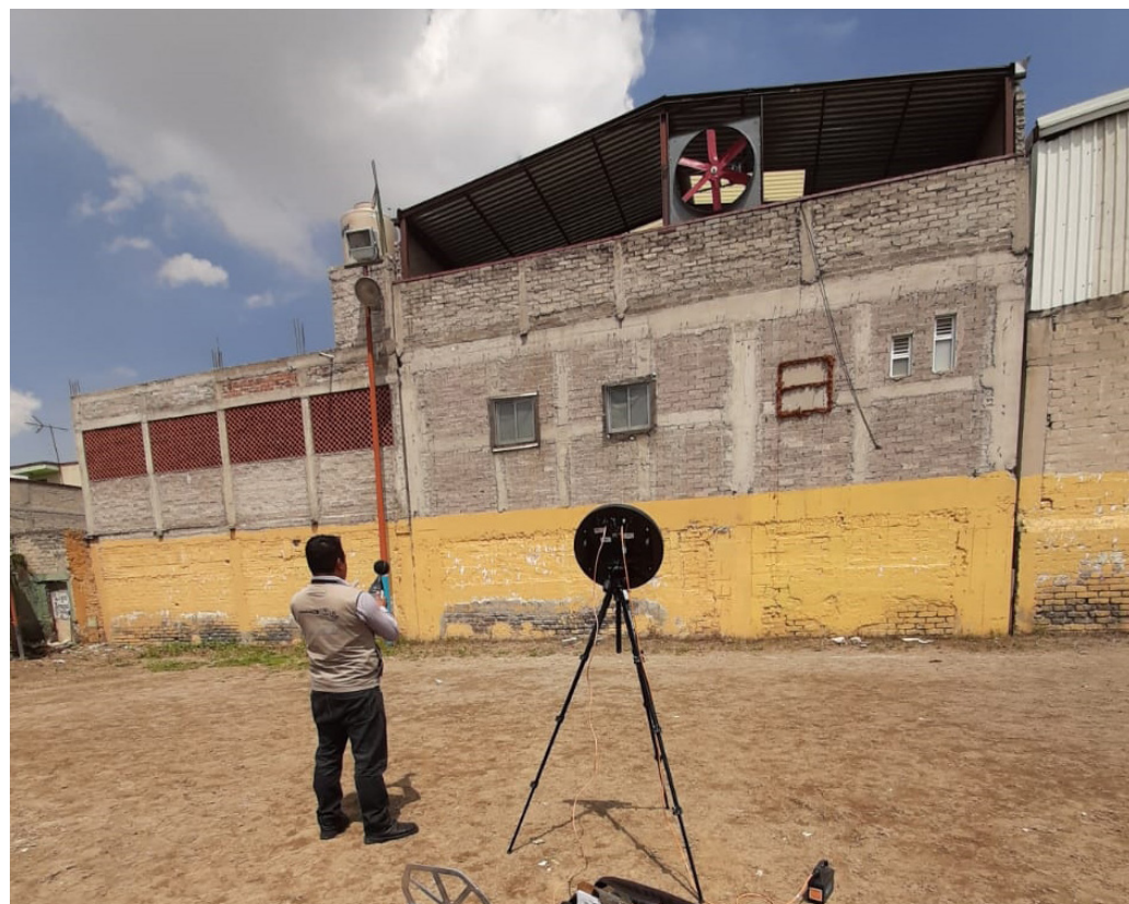
Cámara acústica para medición de ruido
